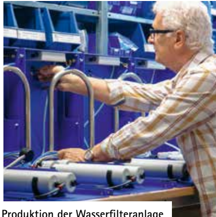
Produktion der Wasserfilteranlage Luzzi: Die Filter funktionieren nach dem Prinzip der Umkehrosmose.
