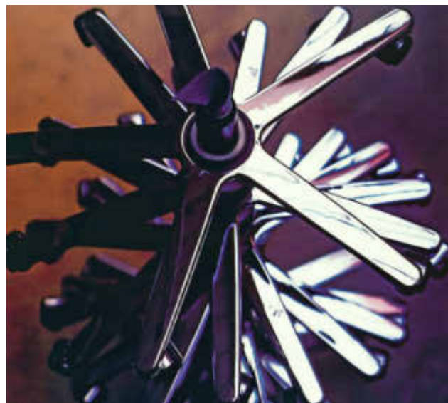
35 Prozent aller Sedus-Büromöbel werden in der Ausführung „verchromt“ bestellt. Das Unternehmen hat seine Galvanikanlage im Werk Dogern von Chrom VI auf das umweltfreundlichere Chrom III umgestellt.
