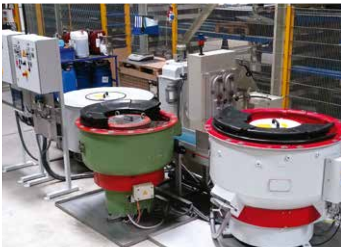
Mit der Gleitschleifanlage „läuft alles rund“
