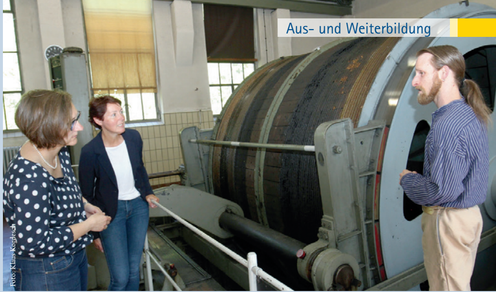
Christian Freiling (vorne) erläutert Aline Heckmann und Ines Kunz die Seilfahranlage im Fördermaschinenhaus der Grube Fortuna, über die der Förderkorb durch den Hauptschacht des Besucherbergwerks bewegt wird.
