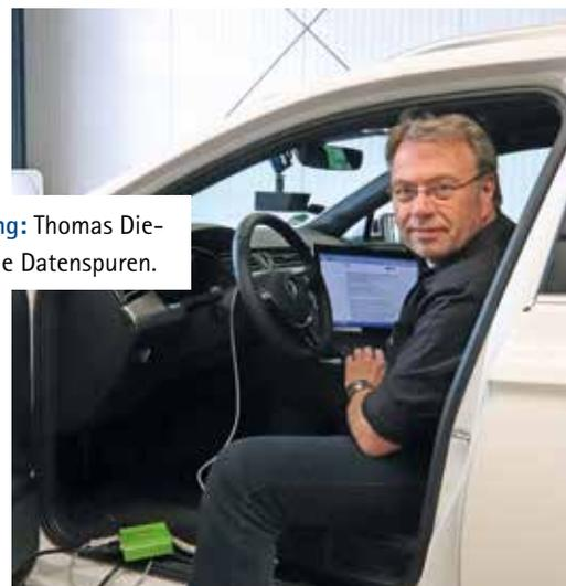
Eine große technische Herausforderung sind zunehmend Unfälle, bei denen Fahrzeuge mit teilautonomen Fahrfunktionen beteiligt sind, z.B. Kollisionswarner oder intelligente Geschwindigkeitsassistenten. Die Sicherung und Auswertung der digitalen Daten ist schwierig, da sie in einem nicht einfach lesbaren Format und oft auch verschlüsselt sind.
