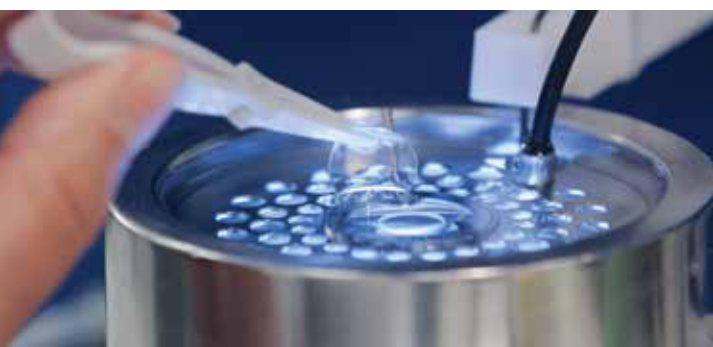
Messung einer Kontaktlinse mit einem Ultraschallmessgerät
