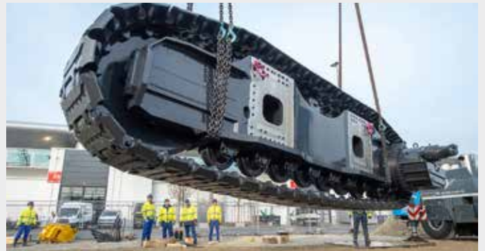
Schwerstarbeit: Die beiden Seitenträger, die „Raupenketten“, wiegen jeweils 54 Tonnen. Jedes Teil ist 9 Meter lang und 2,5 Meter hoch. Zusammengesetzt wird der Bagger am Ende die Größe eines Einfamilienhauses haben.
