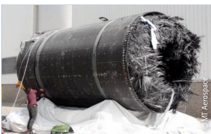
Demonstratorgehäuse nach erfolgreichem Struktur- und Bersttest
