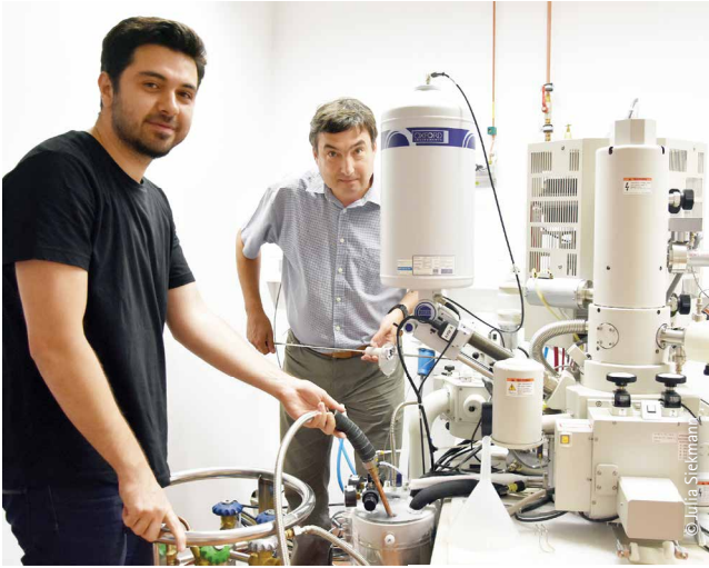
Mit dem Rasterelektronenmikroskop erstellten Professor Stanislav N. Gorb (hinten) und Emre Kizilkan Aufnahmen der nur wenigen Mikrometer großen Oberflächenstrukturen.
