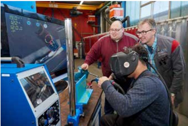
Der Schweißsimulator bewertet am Ende jeder Übung, wie gut die Schweißnaht ist.
