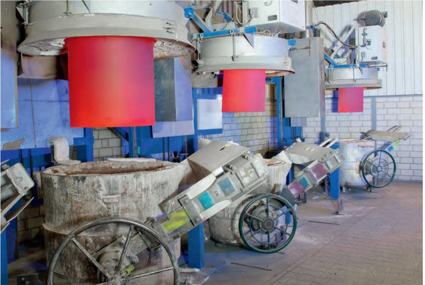
Mit der energieeffizienten Pfannenaufheizstation mit einem neuartigen Porenbrenner zur Erwärmung der Transportpfannen sparen die Edelstahlwerke Schmees jährlich rund 61.400 Kubikmeter Erdgas, ca. 60 Prozent der Energie für die Pfannenbeheizung und damit 113,8 Tonnen CO<sub>2</sub>-Äquivalente ein.
