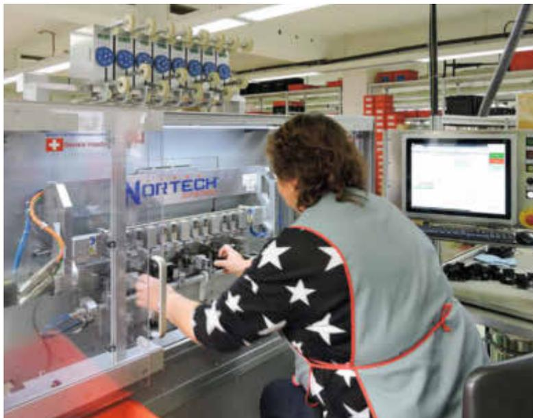
Eine Siedle-Mitarbeiterin bedient die neue Wickelmaschine für Versorgungsgeräte mit Spulen.
