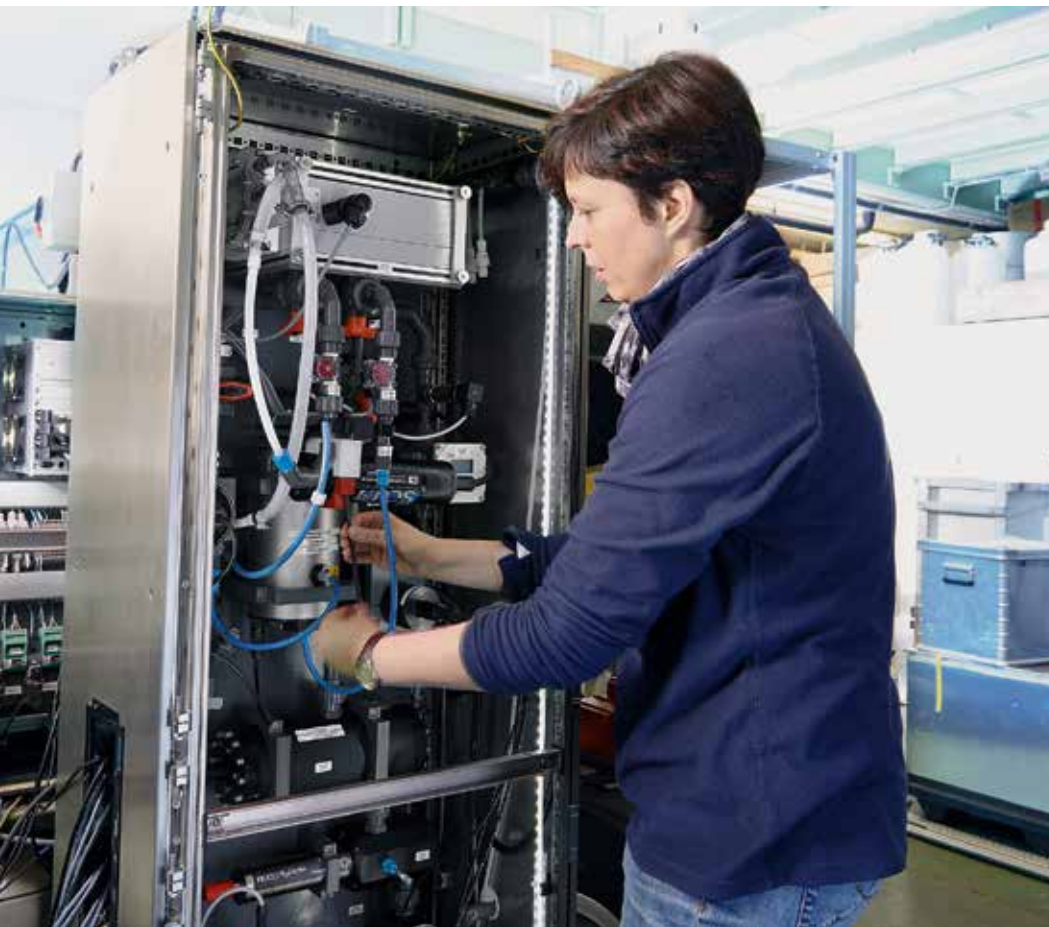
Vorbereitung einer FerryBox im Labor für ihren späteren Einsatz auf einem Schiff
