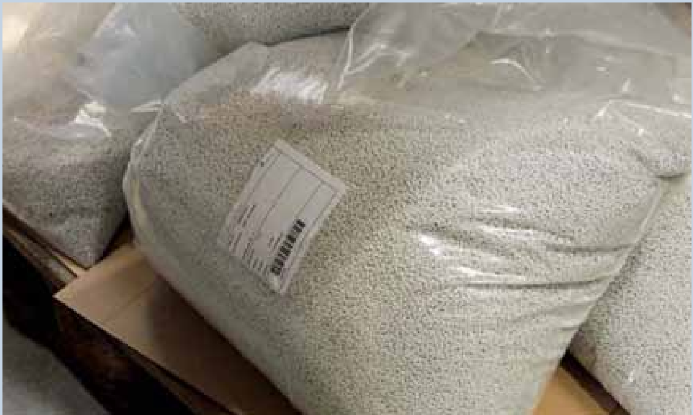
Für die Spritzgussverarbeitung der Rohstoff: Granulat
