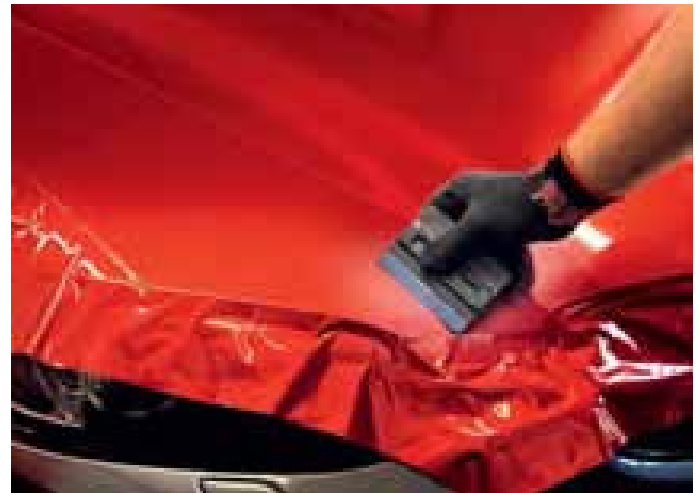
Die verklebte Folie passt sich den Fahrzeug-Konturen an
