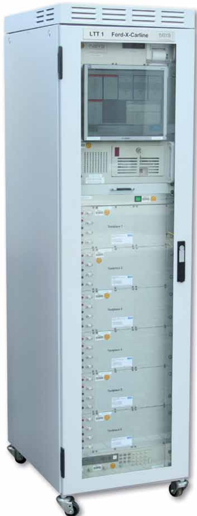
Ein komplett ausgestattetes Rack für Prüf- und Testverfahren von Steuergeräten im Automotive-Bereich.
