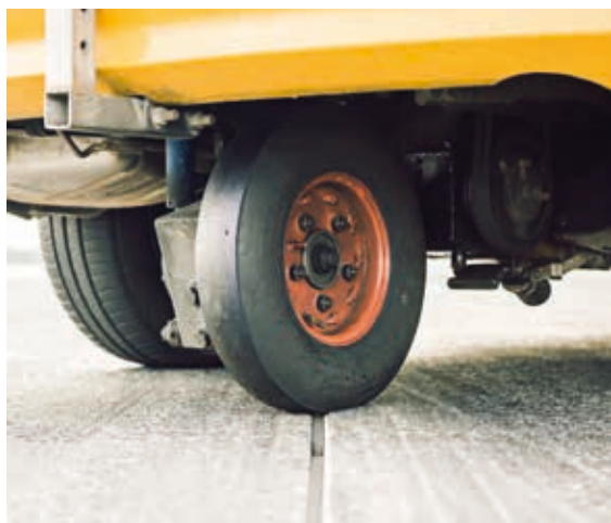
Messrad des Friction Testers.
