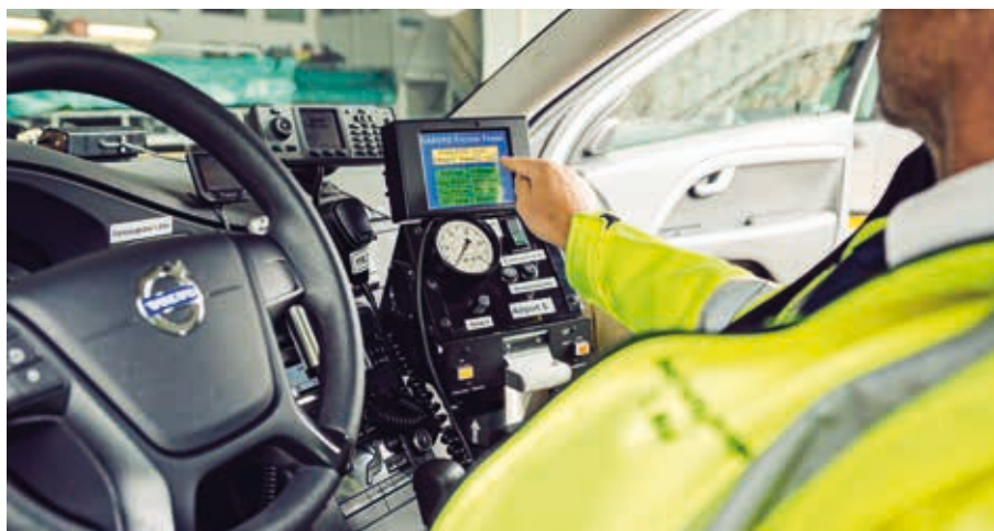
Die Messgeräte im Fahrzeuginneren werten die Daten des Messrads aus.
