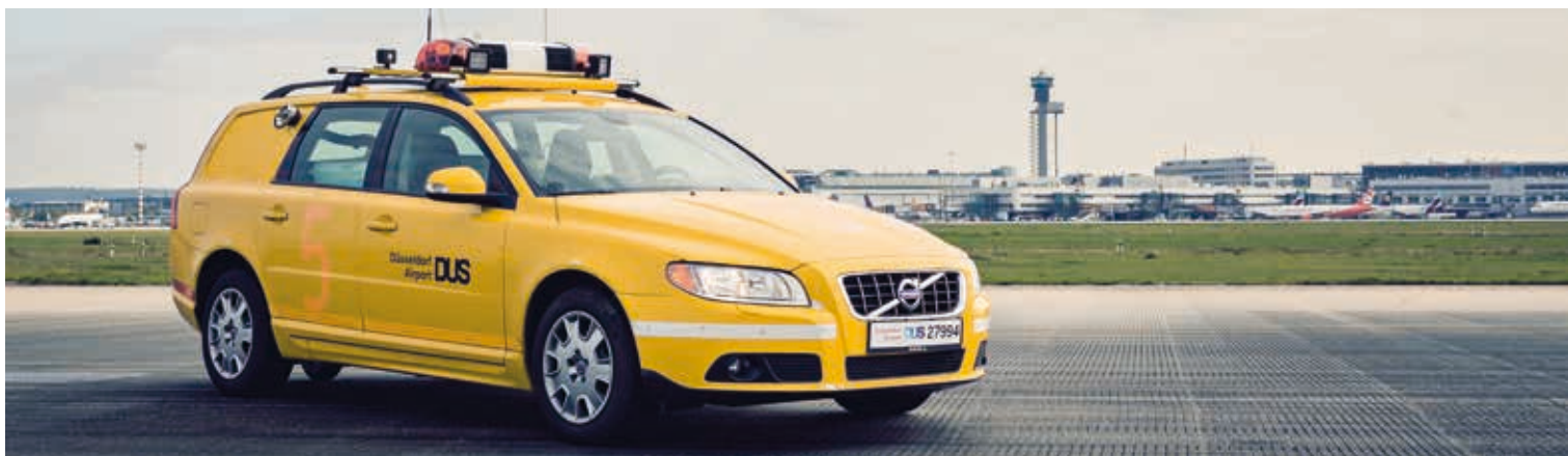
Der Friction Tester misst regelmäßig die Bremswerte auf den Start- und Landebahnen.
