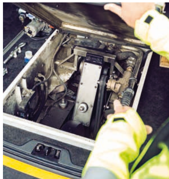
Die Messgeräte zur Prüfung der Oberflächengriffigkeit der Bahnen befinden sich im Kofferraum des Friction Testers.
