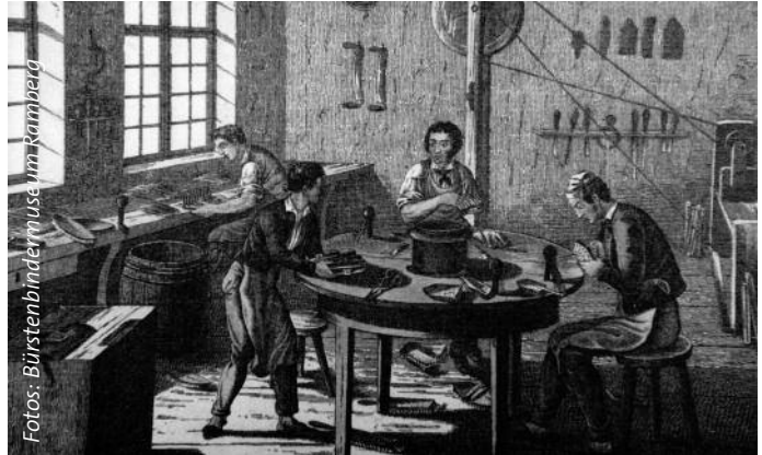
Werkstatt zur Bürstenherstellung mit Einziehtisch
