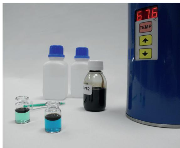
Die Martechnic GmbH hat ein Verfahren entwickelt, um den Anteil von Eisenpartikeln im Zylinderol zu messen.
