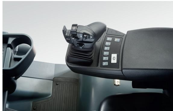
Ein Steuerknüppel statt mehrere Hebel: Der Multi-Pilot
