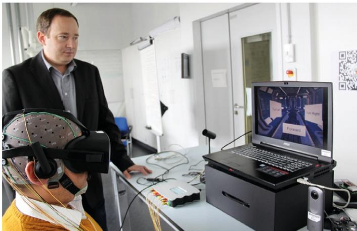
Das heißt: Auf einem Monitor blinken in unterschiedlichen Frequenzen Buchstaben oder Symbole. Diese visuellen Reize lösen eine Gehirnaktivität beim Betrachter aus. Diese Gehirnströme werden per Elektroenzephalogramm (EEG) gemessen und mithilfe der BCI-Technologie in Befehle umgewandelt. Vereinfacht gesagt, werden durch Blicke Wörter gebildet.
