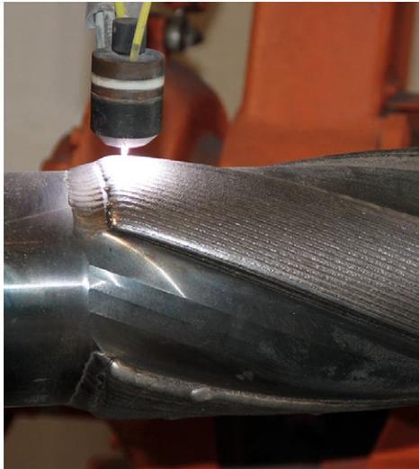
Die erfolgreiche Zusammenarbeit der Willicher DURUM Verschleißschutz GmbH und der Hochschule Niederrhein in Krefeld führte zur Entwicklung einer Technologie, die anstelle des Laserauftragschweißens eingesetzt werden kann. Das Laserauftragschweißen wird beispielsweise angewendet, wenn durch Verschleiß entstandene Schäden an großen Maschinen repariert werden müssen.
