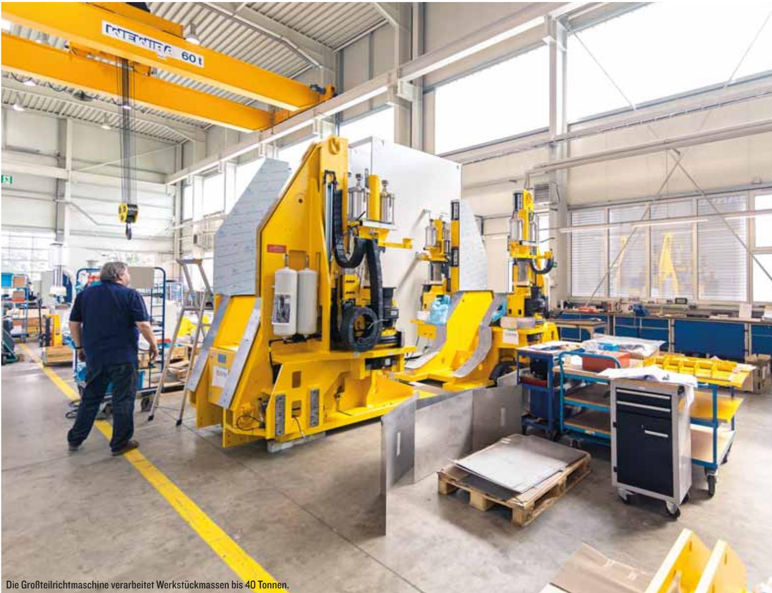
Die Großteilrichtmaschine verarbeitet Werkstückmassen bis 40 Tonnen.
