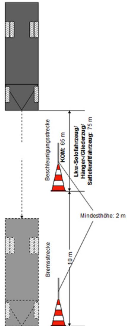
Bewertung: Es ist auf eine gleichmäßige Bremsung zu achten (keine Stotterbremsung). Eine Schlagbremsung ist nicht zulässig. Der automatisierte Eingriff von Assistenzsystemen (zum Beispiel ABS/ABV) wird nicht bewertet und führt somit nicht zu einem Punktabzug.
