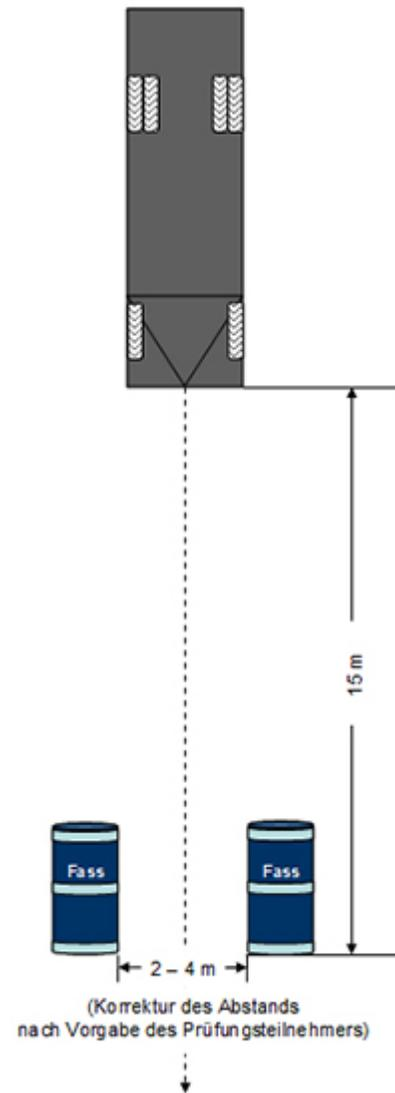
Kennzeichnungen auf der Fahrbahn sind unzulässig. Zur Messung sind handelsübliche Messmittel, wie zum Beispiel ein Maßband zu verwenden.
