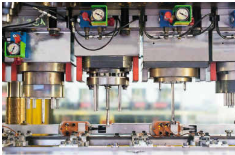
Blick in die Produktion der PWO in Oberkirch – hier die Detailsicht eines Stufenpressenwerkzeugs.
