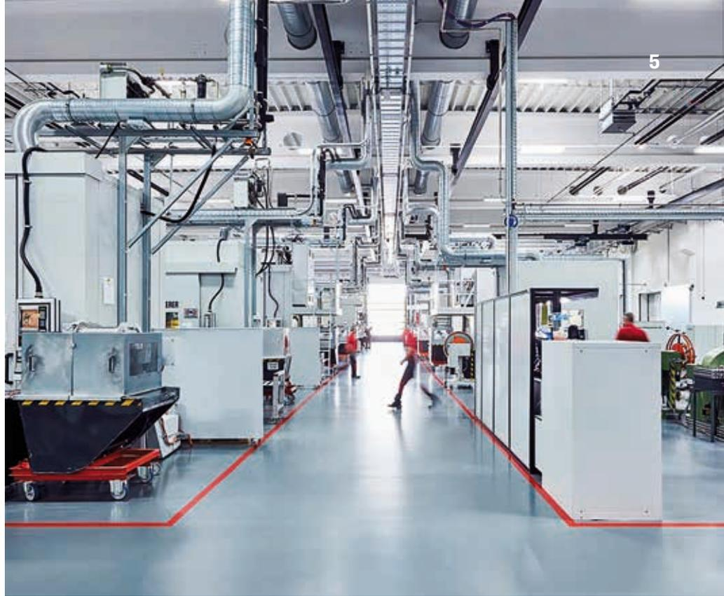
17 Hochleistungs-Stanzautomaten mit CNC-Steuerung produzieren jährlich mehr als 650 Millionen Präzisionsstanzteile.
