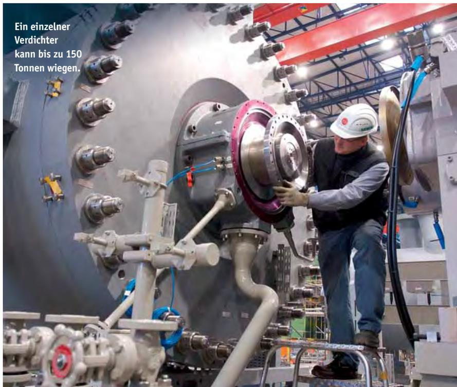
Ein einzelner Verdichter kann bis zu 150 Tonnen wiegen.
