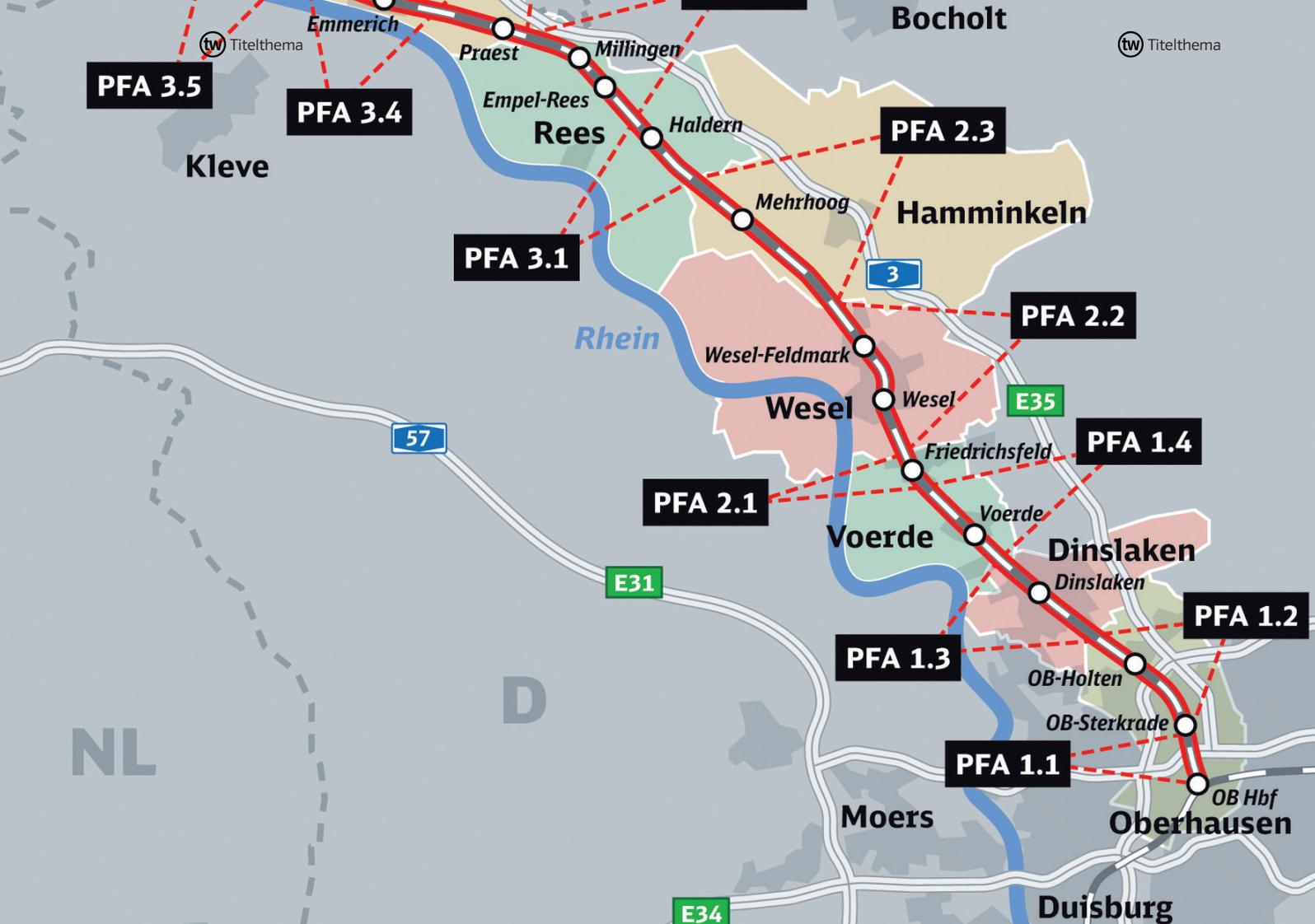
Streckenverlauf des Projekts Ausbaustrecke Emmerich – Oberhausen, Darstellung der zwölf Planfeststellungsabschnitte, für die jeweils ein eigener Planfeststellungsbeschluss gefasst werden muss. © DB ProjektBau GmbH, Regionalbereich West
