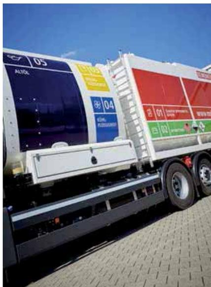
Zum Portfolio der Niederlassung Melle gehört unter anderem das speziell für die mobile Werkstattentsorgung konzipierte MOBIWER, das alle gängigen in Werkstätten anfallenden Abfälle, wie ölhaltige Betriebsmittel, Altöl, Bremsflüssigkeit, Kühlflüssigkeit und Altbatterien entsorgt. Ebenso ist es aber auch möglich private Kleinmengen an festen oder flüssigen gefährlichen Abfällen wie Farb- und Lackreste, Altöl oder überlagerter Chemikalien anzuliefern. Die Reinigung von Fettabscheidern in
