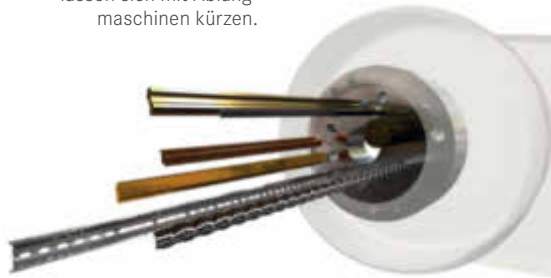
Eine Alternative zum Sägen: Metallstäbe unterschiedlicher Profile lassen sich mit Ablängmaschinen kürzen.
