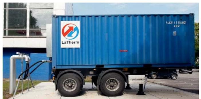
Abb. 49: Mobiler Latentwärmespeicher
