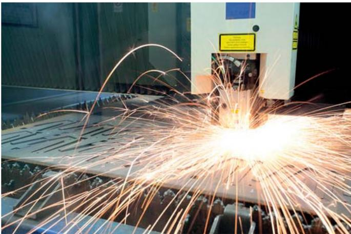
Abb. 6: Abwärmequelle Flachbett-Laser
