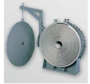
Weiterhin kommt es durch dieses turbulente Strömungsprofil sowie durch die einfache Strömungsführung ohne Umlenkungen und Reduzierungen kaum zu Verschmutzungen der Wärmeübertragerflächen, so dass der Spiralwärmetauscher häufig bei schmutzbelasteten Medien und Suspensionen eingesetzt wird. Wenn sich eine Stirnseite öffnen lässt, ist überdies die Reinigung sehr einfach. Grundsätzlich können sowohl flüssige als auch gasförmige Medien eingesetzt werden.
