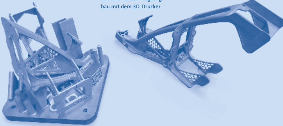
Premium Aerotec fertigt Bauteile für den Flugzeugbau mit dem 3D-Drucker.
