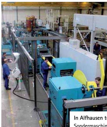
In Alfhausen testweise aufgebaut, aber für China bestimmt: Eine Sondermaschine, die Waschmaschinentrommeln herstellen wird.
