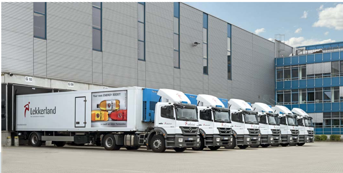
160 Mehrkammer-Lkw sind bei Lekkerland im Einsatz, um die Kunden in drei Temperaturbereichen mit nur einem Stopp zu beliefern (Foto: Peter J. Obenaus)
