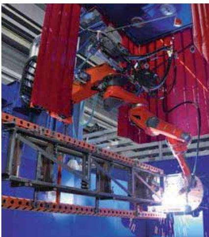
Zum modernen Maschinenpark gehört u. a. ein Schweißroboter.
