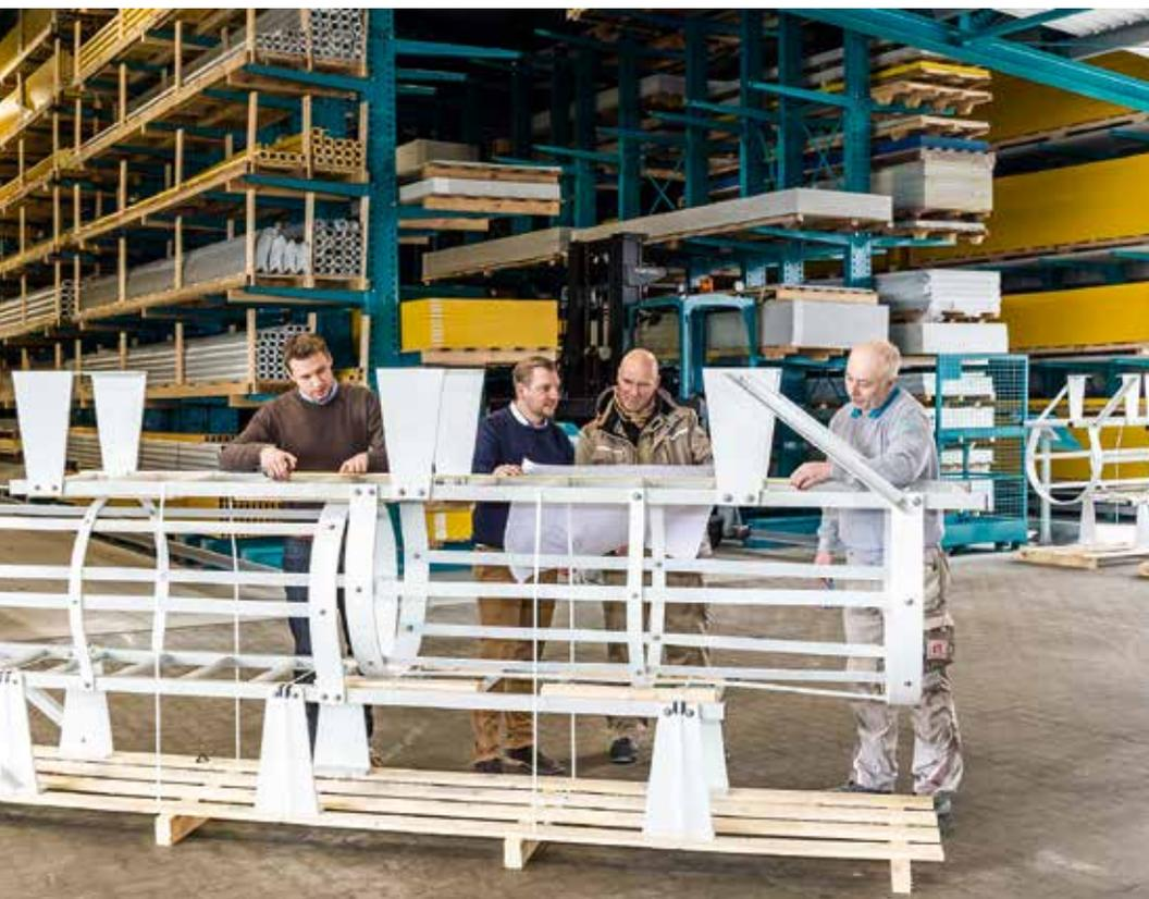
GFK-Leitern mit Rückschutz und Ausgangskontrolle; Zweiter von links: Philipp Wilczek
