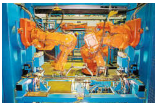
Das Bild zeigt eine Laser-Messzelle von PWO für die automatisierte Qualitätsprüfung von Schweißnähten.
