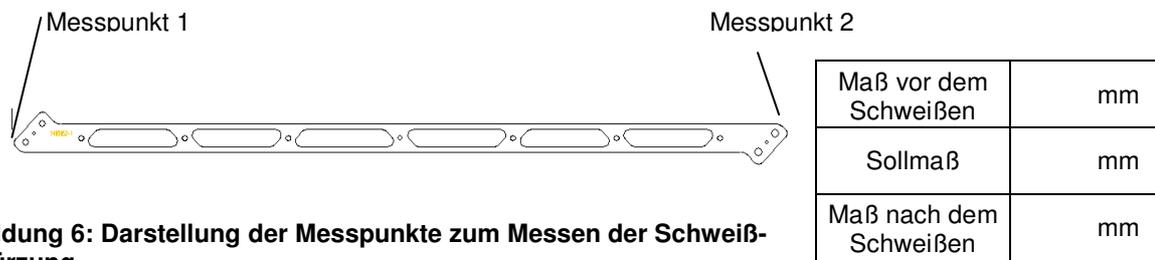
**Abbildung 6: Darstellung der Messpunkte zum Messen der Schweißverkürzung**
