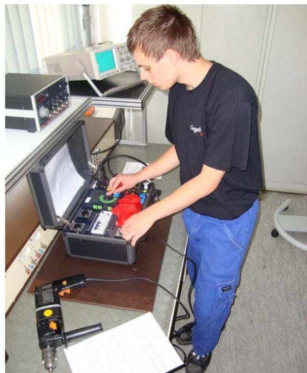
Abb. 2<sup>1)</sup>: Wiederholungsprüfung an einem elektr. Gerät
