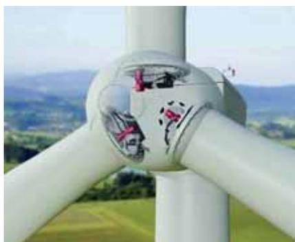
Der Einsatzort des Rotorblattverstellungssystems in der Windenergieanlage.
