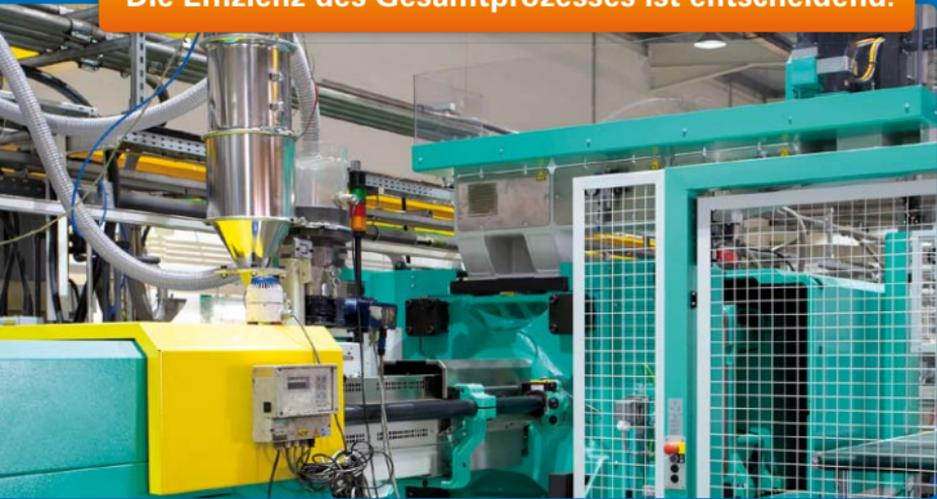
**Im Projekt ZuPrEFF ([www.zupreff.de](http://www.zupreff.de)) konnte der Energieeinsatz im Spritzguss zwischen 28 und 35 Prozent gesenkt werden. Ursache sind unkoordinierte Aufwärm- und Abkühlvorgänge beim Aufschmelzen.**
