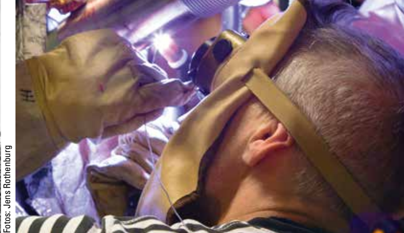
Arbeiter beim Schütten der Beton-Sohle für die Experimentierhalle „Petra Ost“ (links) und Schutzgas-Schweißarbeiten an einem Beschleunigermodul im zukünftigen „European XFEL“ beim Deutschen Elektronen-Synchrotron DESY in Hamburg.
