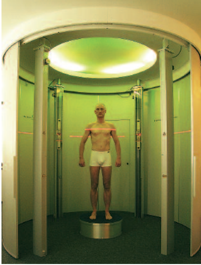
3D-Bodyscanner von Human Solutions der Reihe VITUS vermessen mit mindestens 0,5 mm Genauigkeit und schaffen so die Voraussetzungen für das Simulationsprogramm Vidya.
