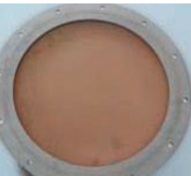
Abb. 28: Gut gereinigter Filter
