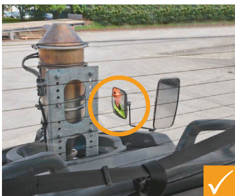
Abb. 20: Beispiele für zusätzliche Spiegel- und Kameramontierung, Monitor in Führerhaus
