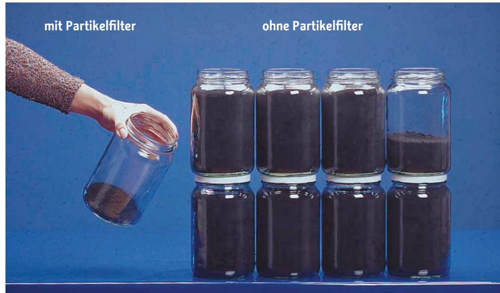
Abb. 4: Rußausstoß eines Euro-III-Pkws im Vergleich: MIT Partikelfilter 100 g und OHNE Partikelfilter 3 kg Ruß
