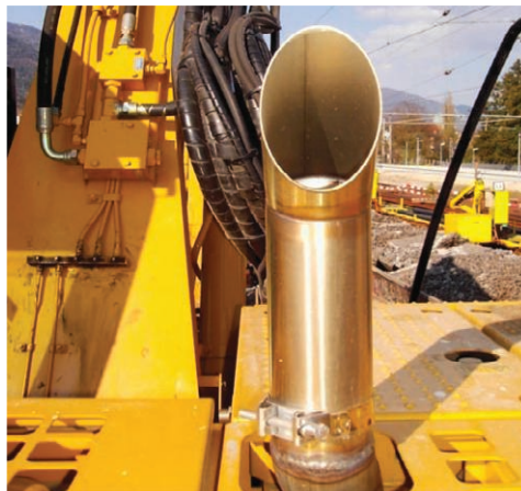
Abb. 5: Sauberes Abgas mit Partikelfilter
