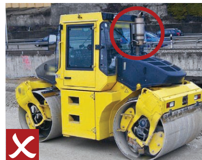
Abb. 19: Falsche und richtige Platzierung des Partikelfilters im Vergleich
