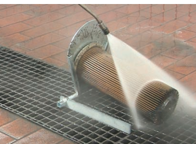
Abb. 30: Reinigung des Filters mit Hilfe eines Hochdruckwasserstrahls
