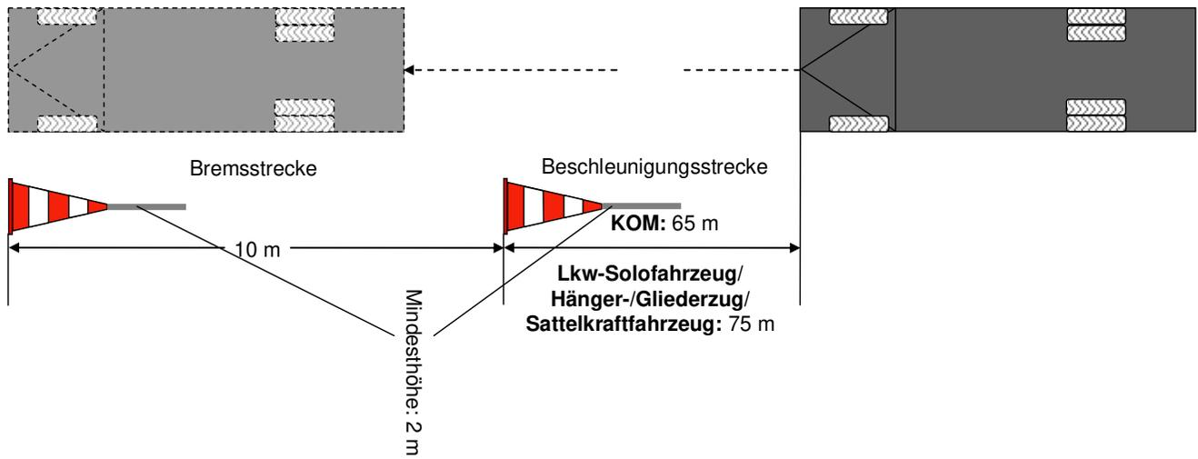
Bewertung: Es ist auf eine gleichmäßige Bremsung zu achten (keine Stotterbremsung). Eine Schlagbremsung ist nicht zulässig. Der automatisierte Eingriff von Assistenzsystemen (zum Beispiel ABS/ABV) wird nicht bewertet und führt somit nicht zu einem Punktabzug.
