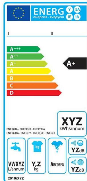
**Abbildung 2:** Blanko-Label für Waschmaschinen
