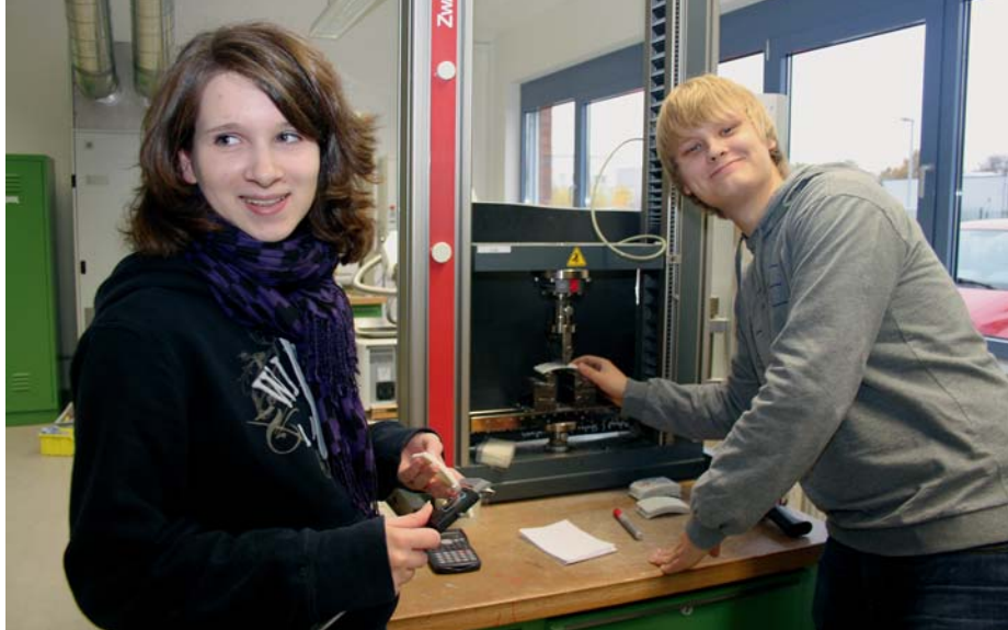
May-Britt Andersson und John Siebert beweisen ihr handwerkliches Geschick und technisches Verständnis – hier prüfen sie ein Kunststoffrohr für Kanalarbeiten.
