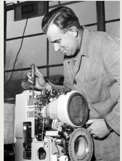
Montage einer Fischlupe bei Elac 1953.
