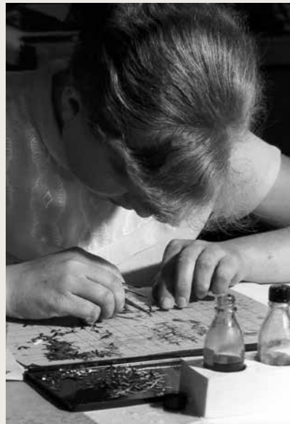
Feinmontage von Tonabnehmern für Elac-Plattenspieler 1952.
