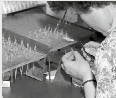
Montage der Glühfäden bei der Speziallampenproduktion der Firma Plechati 1958.
