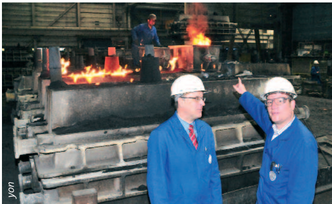
Geschäftsführer Andreas Hecker (l.) überprüft mit Frank Koch, Leiter der Produktion Handformguss, das Befüllen der Motorblock-Gussformen.
