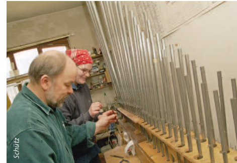
Johannes Zimnol in Kaiserslautern kümmert sich mit der angehenden Meisterin Nora Rütten um die Königin unter den Instrumenten, die Pfeifenorgel. Unser Bild zeigt die Orgelbauer am Intonationstisch, wo die Orgelpfeifen in Stimmung gebracht werden.
