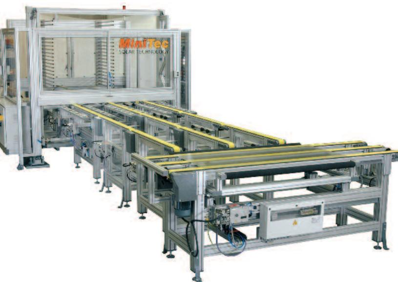
Im Glasspeicher werden die Glasscheiben für das Lay-up bereitgestellt; hier dürfen sie wegen ihrer Lichtempfindlichkeit maximal eine Stunde liegen, sich nicht durchbiegen und keinerlei Staub ausgesetzt sein.
